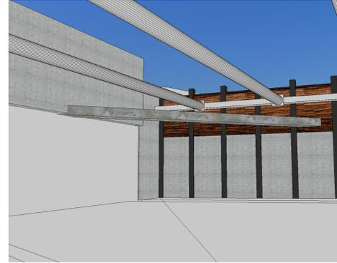
Perspektive 3 - Betonausfachungen links und rechts beim Bauwerk; Platz lassen für Abdichtung
