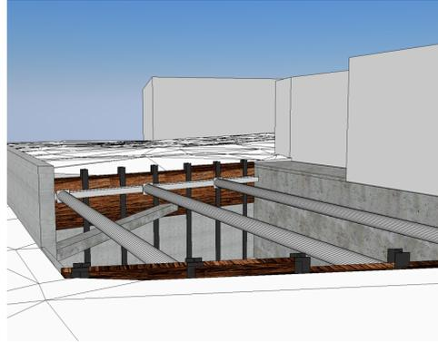
Perspektive 2 - Best. Swisscom-Kabel nach Abbruch Schacht an Aussteifung aufhängen
