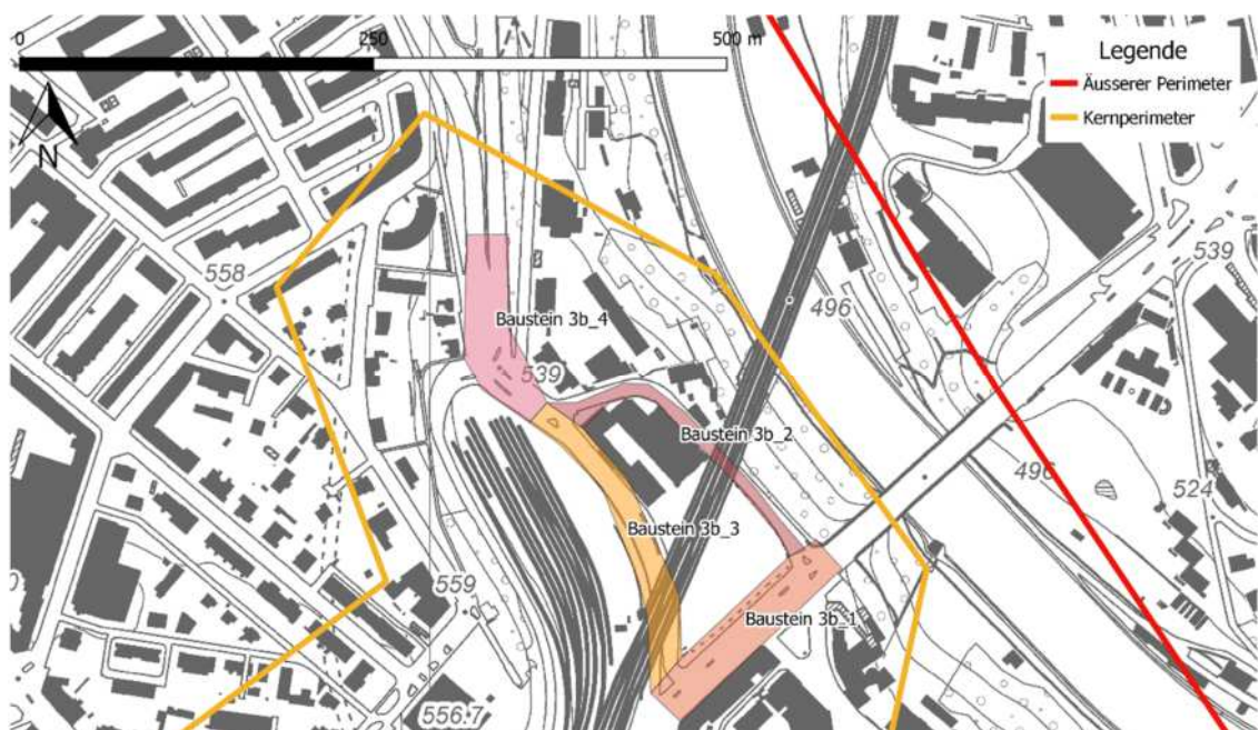
Fig. 34 Strassenabschnitte des Bausteins 3b
