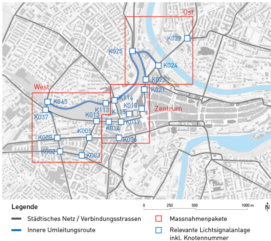
Abbildung 11: Verkehrslenkung und Massnahmenpakete Kernperimeter
